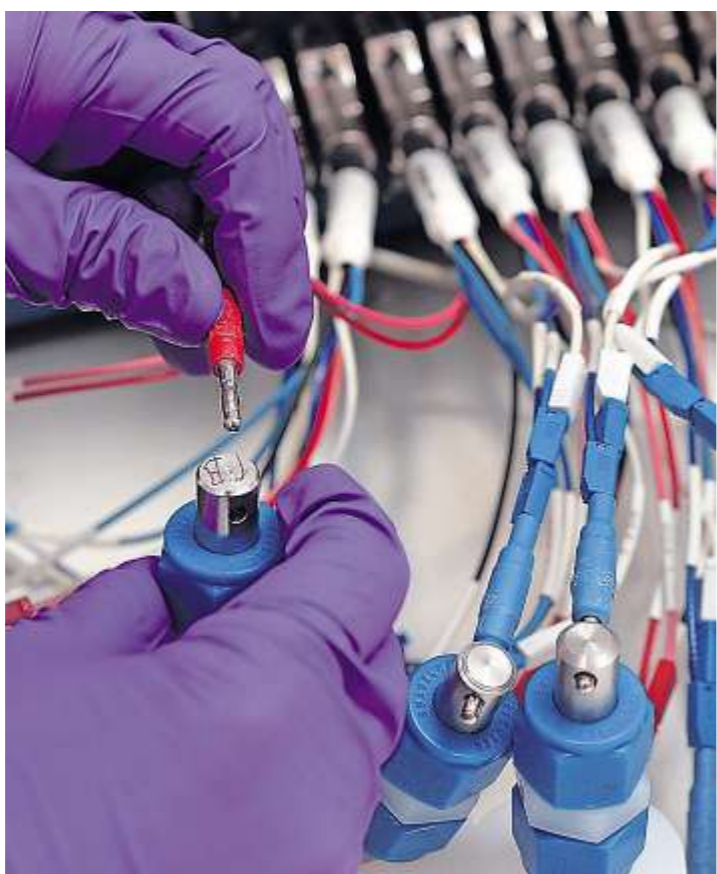
Stresstest. Forscher prüfen, wie gut sich neue Materialien aus nachwachsenden Rohstoffen für Batterien eignen. Foto: Bettina Ausserhofer
